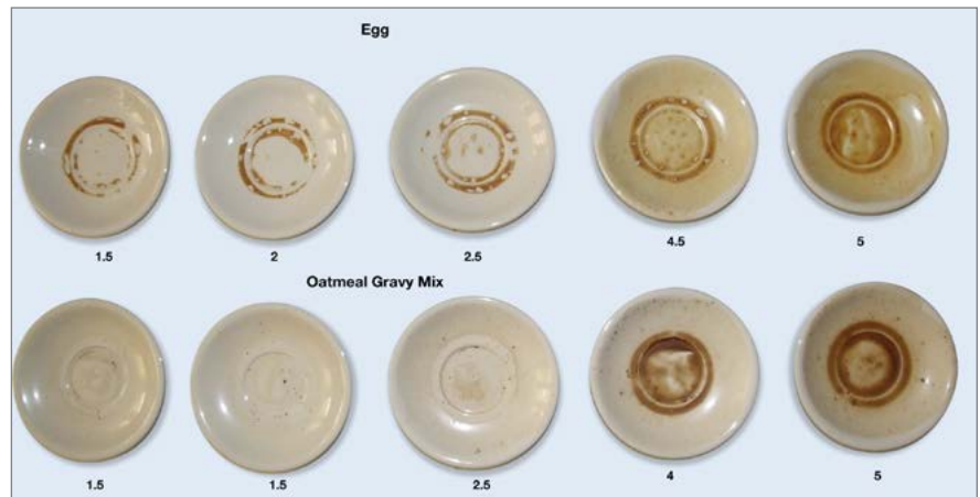
Dieses Foto zeigt Beispiele für ein Bewertungssystem für Ei- und Haferflocken-Rückstände. Das Bewertungssystem wird verwendet, um die Sauberkeit der Teller nach dem Spülen in einer industriellen Geschirrspülmaschine zu bestimmen.
