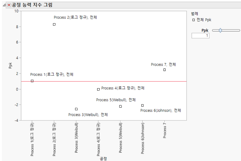
그림 9.13 비정규 분포가 포함된 공정 능력 지수 그림
